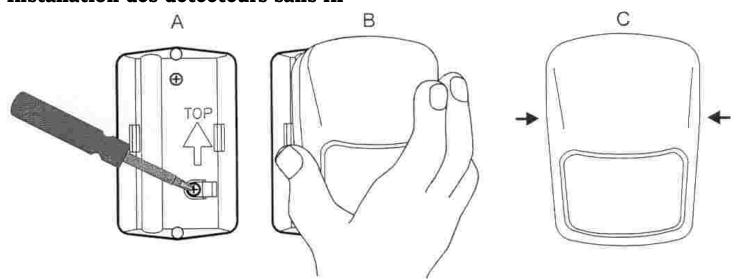
Ne placez pas les détecteurs à proximité d'objets métalliques car cela risque d'entraver la radio communication. Lorsque vous aurez choisi l'emplacement des détecteurs, prenez en considération le fait que les piles d'un détecteur doivent être remplacées régulièrement (environ une fois par an).
