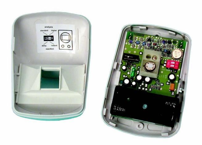
L'infrarouge sans fil (réf. JA60P) fonctionne en association avec les centrales d'alarmes sans fils (réf. JA60K, JA65K+JA65R), les récepteurs 3 canaux 12V (réf. UC216), les récepteurs 1 canal 220V (réf. UC222), les récepteurs avec sonnette 220V (réf. UC260), les récepteurs 12 canaux 15/24V (réf. UC240), les interface 8 canaux (réf. UC280 ou UC281)
